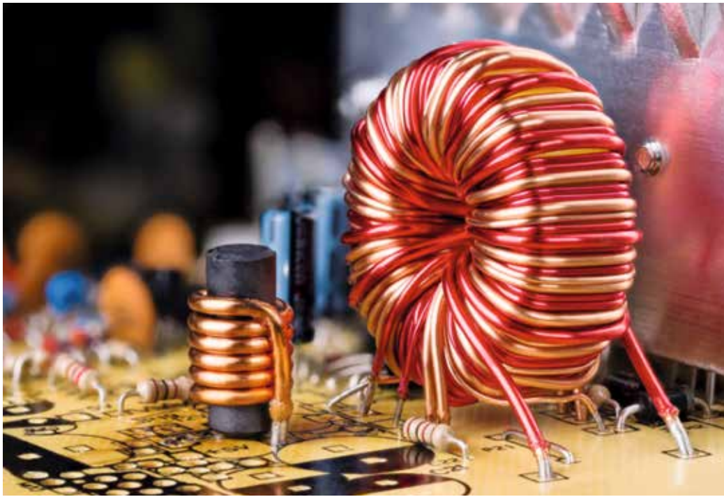
← In primo piano due induttori di un circuito stampato
